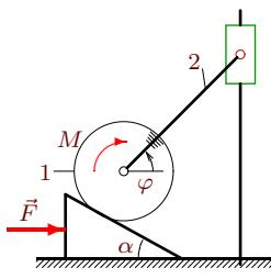
Цилиндр радиусом  $R$  опирается без проскальзывания на подвижную призму. Цилиндр жестко соединен со стержнем длиной  $L$ , шарнирно связанным с ползуном. Ползун движется по вертикальной направляющей. Масса цилиндра равна  $m_1$ , масса стержня —  $m_2$ . К призме приложена горизонтальная сила  $F$ , к цилинду — момент  $M$ . Составить уравнение движения системы. За обобщенную координату принять угол поворота стержня  $\varphi$ .
