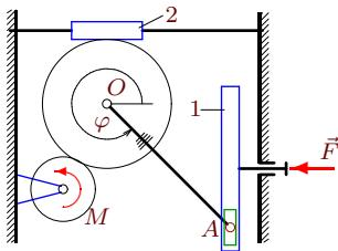
Цилиндр радиусом  $R$  находится в зацеплении с вращающимся диском радиусом  $r$  и горизонтально движущейся муфтой. Кривошип  $OA$  жестко соединен с цилиндром. Ползун  $A$ , шарнирно закрепленный на кривошипе, скользит в прорези кулисы;  $OA = a$ . К штоку кулисы приложена горизонтальная сила  $\vec{F}$ , к диску — момент  $M$ . Масса кулисы равна  $m_1$ . Масса муфты равна  $m_2$ . Составить уравнение движения системы. За обобщенную координату принять угол поворота кривошипа  $\varphi$ .
