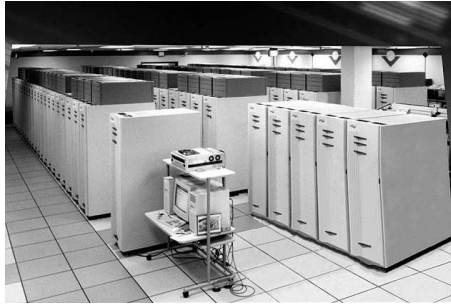
Рис.4. Кластерный суперкомпьютер ASCI Red с производительностью в 1 Тфлоп (1996 г.)
