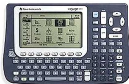
Рис.1. Современный микрокалькулятор TI Voyage 200 с встроенной системой компьютерной алгебры Derive.
