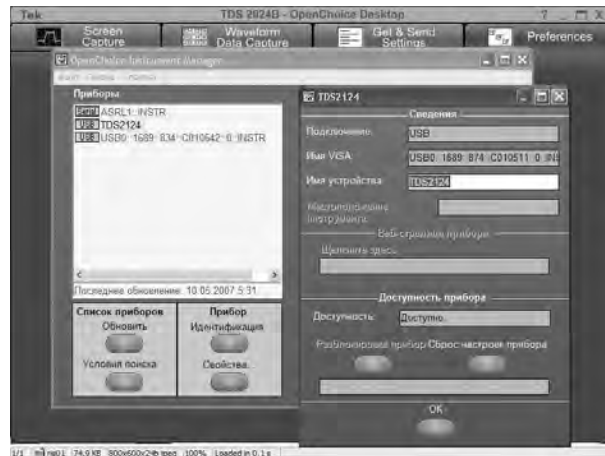
Рис.1. Определение имени VISA-устройства для осциллографа TDS2024B
