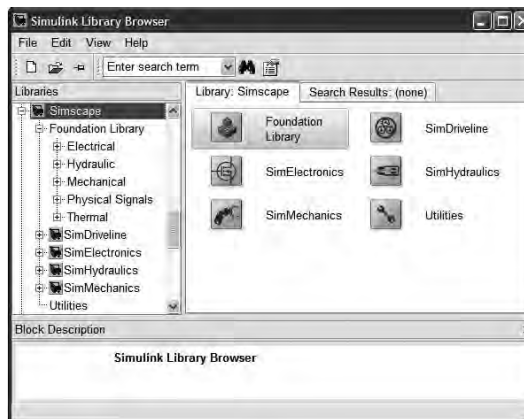
Рис.1. Состав библиотеки блоков пакета расширения Simscape
