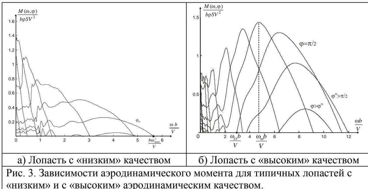
Основной характеристикой ветротурбины является вырабатываемая мощность. Поэтому приведем также графики семейств зависимости мощности  $N = \omega M_a(\omega, \varphi)$  (рис. 4 а,б).
