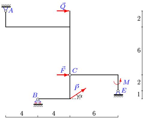
$P=1\text{кН}$ ,  $Q=2\text{кН}$ ,  $F=2\text{кН}$ ,  $M = 5\text{кНм}$ ,  $\alpha=30^\circ$ .
