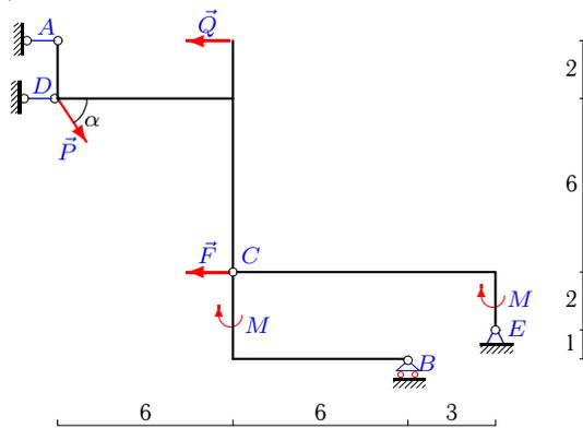
$P=7\text{кН}$ ,  $Q=3\text{кН}$ ,  $F=6\text{кН}$ ,  $M = 6\text{кНм}$ ,  $\alpha=60^\circ$ .
