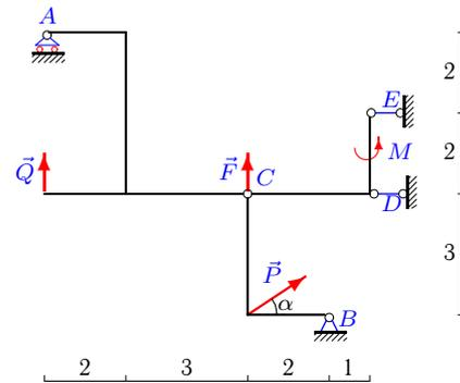
$P=7\text{кН}, Q=5\text{кН}, F=5\text{кН}, M=4\text{кНм}, \alpha=30^\circ.$
