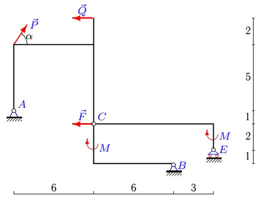
$P=7\text{кН}$ ,  $Q=8\text{кН}$ ,  $F=3\text{кН}$ ,  $M = 6\text{кНм}$ ,  $\alpha=60^\circ$ .
