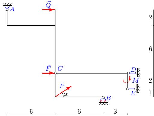
$P=4\text{кН}, Q=4\text{кН}, F=7\text{кН}, M=6\text{кНм}, \alpha=30^\circ.$
