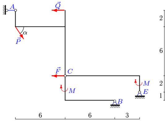
$P=1\text{кН}$ ,  $Q=6\text{кН}$ ,  $F=1\text{кН}$ ,  $M = 6\text{кНм}$ ,  $\alpha=60^\circ$ .
