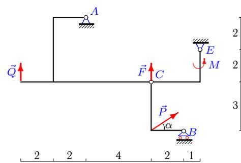
$P=9\text{кН}$ ,  $Q=3\text{кН}$ ,  $F=2\text{кН}$ ,  $M = 4\text{кНм}$ ,  $\alpha=30^\circ$ .
