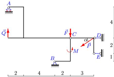
$P=1\text{кН}, Q=7\text{кН}, F=5\text{кН}, M = 5\text{кНм}, \alpha=30^\circ.$
