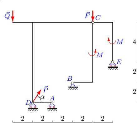
$P=8\text{кН}$ ,  $Q=3\text{кН}$ ,  $F=8\text{кН}$ ,  $M = 5\text{кНм}$ ,  $\alpha=60^\circ$ .
