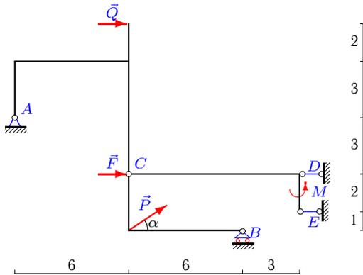
$$P=8\text{кН}, Q=5\text{кН}, F=7\text{кН}, M=6\text{кНм}, \alpha=30^\circ.$$
