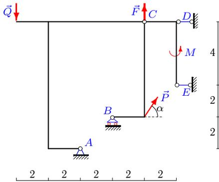
$$P=2\text{кН}, Q=6\text{кН}, F=7\text{кН}, M=5\text{кНм}, \alpha=60^\circ.$$
