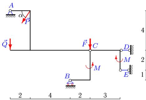
$P=6\text{кН}$ ,  $Q=2\text{кН}$ ,  $F=7\text{кН}$ ,  $M = 5\text{кНм}$ ,  $\alpha=60^\circ$ .
