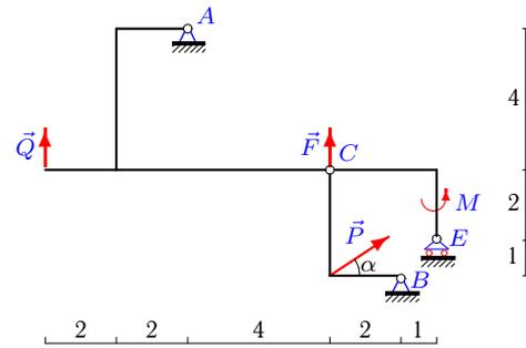
$P=8\text{кН}, Q=5\text{кН}, F=3\text{кН}, M=6\text{кНм}, \alpha=30^\circ.$
