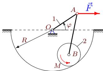
Диск радиусом  $r$  катится по цилиндрической поверхности радиусом  $R = 5r$ . Шарнирный двухзвенник  $OAB$  соединяет ось диска и неподвижную опору в центре цилиндрической поверхности;  $OA = 4r$ ,  $AB = 4\sqrt{2}r$ . К шарниру  $A$  приложена горизонтальная сила  $F$ , к диску — момент  $M$ . Масса кривошипа равна  $m_1$ , диска —  $m_2$ . Составить уравнение движения системы. За обобщенную координату принять угол поворота кривошипа  $\varphi$ .
