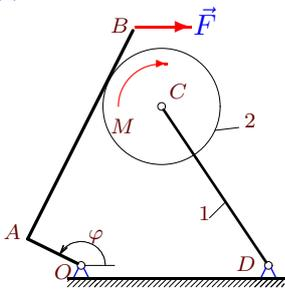
Уголок  $OAB$  из двух жестко скрепленных под прямым углом стержней вращается на шарнире  $O$ . Цилиндр радиусом  $R$ , шарнирно закрепленный на конце кривошипа  $CD$ , катится по уголку.  $OA = R$ ,  $AB = l$ ,  $OD = DC = b$ . Масса кривошипа  $m_1$ , масса цилиндра —  $m_2$ . К уголку приложена горизонтальная сила  $\vec{F}$ , к цилиндру — момент  $M$ . Составить уравнение движения системы. За обобщенную координату принять угол поворота  $\varphi$ .
