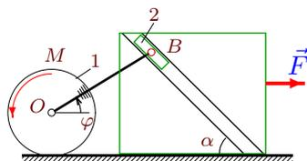
Цилиндр радиусом  $R$ , массой  $m_1$ , катится без проскальзывания по горизонтальной поверхности. Стержень  $OB$  жестко соединен с цилиндром. Ползун  $B$ , шарнирно закрепленный на кривошипе, скользит в наклонной прорези призмы, движущейся по гладкой плоскости;  $OB = a$ . Масса ползуна равна  $m_2$ . Составить уравнение движения системы. За обобщенную координату принять угол поворота кривошипа  $\varphi$ .
