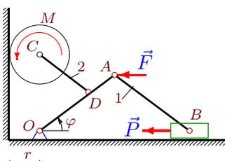
Механизм состоит из трех шарнирно соединенных стержней, ползуна и цилиндра радиусом  $r$ . Цилиндр катится по вертикальной плоскости, ползун скользит горизонтально;  $OA = AB = a$ ,  $CD = OD = b$ . К шарниру  $A$  и к ползуну приложены горизонтальные силы  $\vec{F}$  и  $P$ , к цилиндру — момент  $M$ . Масса стержня  $AB$  равна  $m_1$ , стержня  $DC$  —  $m_2$ . Составить уравнение движения системы. За обобщенную координату принять угол поворота кривошипа  $\varphi$ .
