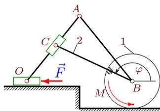
Стержень  $BC$  жестко скреплен с цилиндром радиуса  $R$ , катящимся без проскальзывания по горизонтальной поверхности. Муфта  $C$  скользит по стержню  $AO$ . Стержни  $AO$  и  $AB$  шарнирно соединены, ползун  $O$  движется горизонтально. К цилиндру приложен момент  $M$ , к ползуну — сила  $F$ ;  $OA = AB = BC = a$ . Масса цилиндра равна  $m_1$ , масса стержня  $BC$  —  $m_2$ . Составить уравнение движения системы. За обобщенную координату принять угол поворота стержня  $BC$   $\varphi$ .
