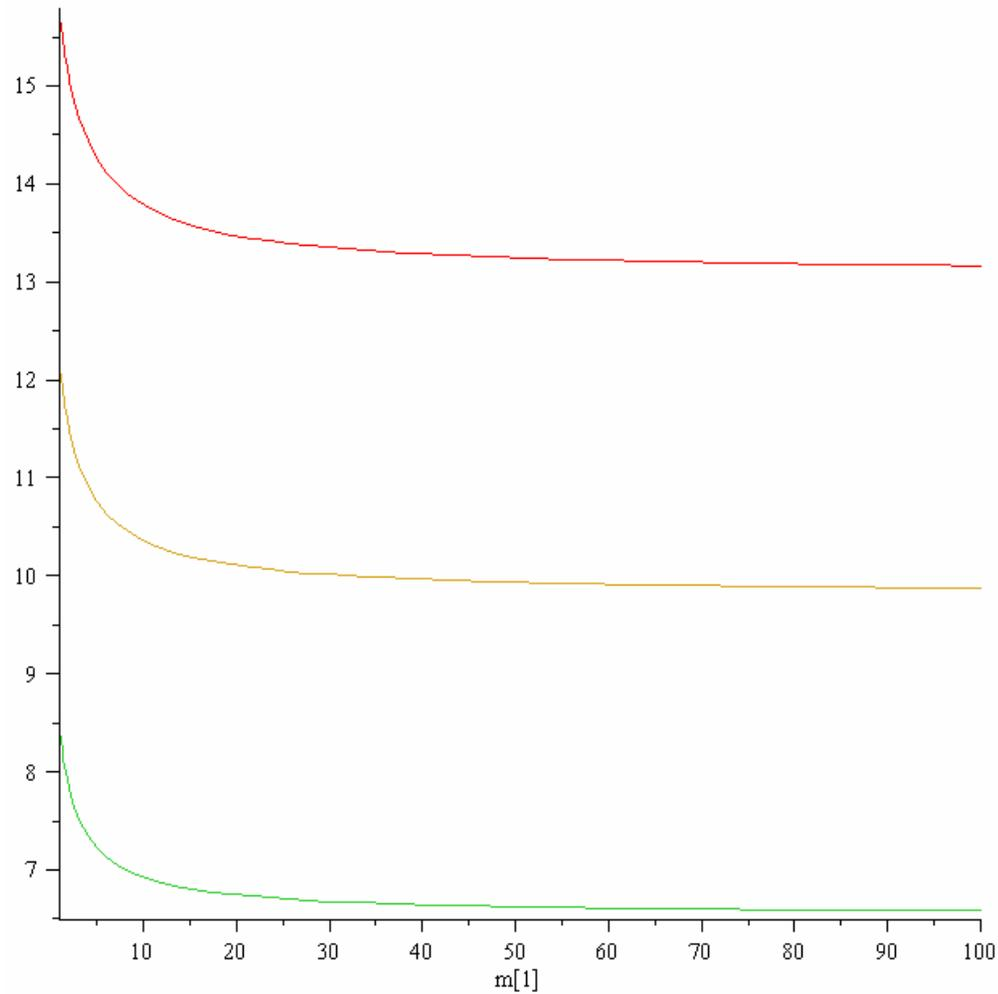
График показывает как зависит частота собственных колебаний системы от массы цилиндра при различной массе бруска.
