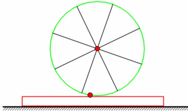
Решена задача кинематики. За обобщенные координаты принимаем смещение бруска  $x$  и угол поворота цилиндра  $\varphi$
