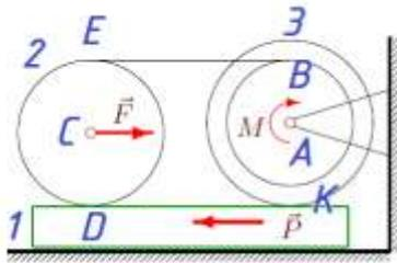
Цилиндр катится без проскальзывания по бруску, скользящему по гладкой горизонтальной поверхности. Цилиндр и блок с неподвижной осью с внешним радиусом 4 см и внутренним 2 см связаны нитью. Радиус инерции блока 3 см. Масса блока равна 1 кг, бруска — 1 кг. К цилиндру приложен момент  $M = 9 \text{ Нсм}$ , к оси блока — сила  $F = 9 \text{ Н}$ , к бруску — сила  $P = 150 \text{ Н}$ . Найти ускорение бруска.
