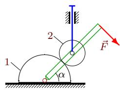
Полуцилиндр массой 10 кг радиусом 1 м скользит по гладкой плоскости. По его поверхности катится диск массой 10 кг радиусом 50 см, шарнирно закрепленный на штоке. Оси диска и полуцилиндра соединяют планка длиной 3 м, к концу которой перпендикулярно ей приложена сила  $F = 30$  Н. Механизм расположен в горизонтальной плоскости. Найти угловое ускорение планки при  $\alpha = \pi/4$ .
