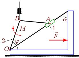
Муфта  $A$  скользит по наклонному стержню, закрепленному на платформе, расположенной на гладкой плоскости. Шарнирный двухзвенник  $OBA$ , составленный из стержней одинаковой длины  $a$ , соединен с вертикальным штоком. К платформе приложена горизонтальная сила  $F$ , к стержню  $OB$  — момент  $M$ . Масса муфты равна  $m_1$ , масса стержня  $OB$  —  $m_2$ . Составить уравнение движения системы. За обобщенную координату принять угол поворота стержня  $OB$   $\varphi$ .
