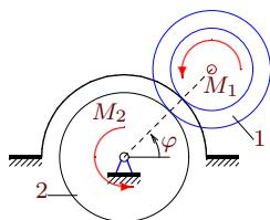
По цилиндрической поверхности радиусом  $R$  катится внутренним ободом радиуса  $r_1$  блок массой  $m_1$ . Своим внешним ободом блок касается цилиндра массой  $m_2$ , приводя его во вращение. К цилинду приложен момент  $M_2$ , к блоку —  $M_1$ . Момент инерции блока  $J$ , радиус цилиндра  $r_2$ . Составить уравнение движения системы. За обобщенную координату принять угол  $\varphi$ .
