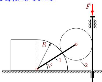
По боковой цилиндрической поверхности груза, скользящего горизонтально, катится диск радиусом  $r$ . Ось диска соединена с центром цилиндрической поверхности стержнем длиной  $R + r$ . С другой стороны диск катится по поверхности вертикального штока. Масса стержня равна  $m_1$ , масса диска —  $m_2$ . К штоку приложена вертикальная сила  $F$ . Составить уравнение движения системы. За обобщенную координату принять угол поворота стержня  $\varphi$ .
