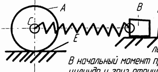
катитьсяся без скольжения по горизонтальной шероховатой плоскости E, связана при помощи пружины жесткостью  $C$  с грузом массы  $m$ , который лежит на горизонтальной гладкой плоскости K
