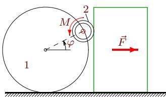
Цилиндр радиусом  $R$ , массой  $m_1$ , катится без проскальзывания по горизонтальной поверхности. На ободе цилиндра закреплена ось колеса радиусом  $r$ , катящегося по боковой поверхности груза. Масса колеса  $m_2$ , радиус инерции  $i$ . К грузу, скользящему по гладкой поверхности, приложена горизонтальная сила  $F$ , к колесу — момент  $M$ . Составить уравнение движения системы. За обобщенную координату принять угол поворота цилиндра  $\varphi$ .
