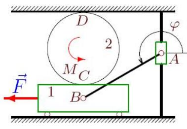
По вертикальной направляющей движется муфта A, шарнирно соединенная с бруском. Верхней точкой обода диска касается горизонтальной поверхности, нижней – бруска массой  $m_1$  на невесомых подшипниках. Масса диска  $m_2$ .  $AB = a$ . Составить уравнение движения системы. За обобщенную координату принять  $\varphi$ .
