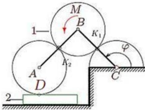
Оси цилиндров  $A$  и  $B$  радиусами  $R$ , находящиеся в зацеплении, шарнирно соединены звеном  $AB$ . Цилиндр  $B$  массой  $m_1$  катится по неподвижному цилиндру радиусом  $R$ , цилиндр  $A$  опирается на пластину массой  $m_2$ , скользящую по горизонтальной поверхности. К цилиндру  $B$  приложен момент  $M$ . Составить уравнение движения системы. За обобщенную координату принять угол поворота стержня  $CB$   $\varphi$ .
