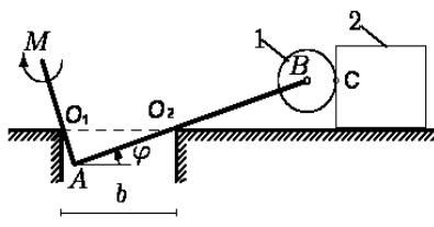
Невесомый уголок, составленный из двух жестко соединенных взаимно перпендикулярных стержней, опирается на гладкие опоры. Диск радиуса  $r$ , закрепленный на конце стержня длиной  $AB = a$ , катится по боковой поверхности груза, скользящего по гладкой плоскости. К уголку приложен момент  $M$ . Масса диска равна  $m_1$ , груза —  $m_2$ . Составить уравнение движения системы. За обобщенную координату принять угол поворота уголка  $\varphi$ .
