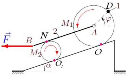
**30.21.** Два цилиндра катятся по плоскости, наклоненной под углом  $\alpha$ . Точка массой  $m_1$  расположена на ободе невесомого цилиндра  $A$  радиусом  $R$ . Стержень  $AB$  массой  $m_2$  лежит на невесомом цилиндре  $C$  радиусом  $R/2$ . Момент  $M_1$  приложен к цилиндру  $A$ , момент  $M_2$  — к цилиндру  $C$ , горизонтальная сила  $F$  — к стержню. Составить уравнение движения системы. За обобщенную координату принять угол поворота  $\varphi$  цилиндра  $A$ .
