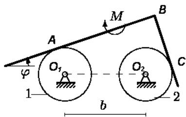
Невесомый уголок, составленный из двух жестко соединенных взаимно перпендикулярных стержней, опирается без проскальзывания на два диска радиусов  $R$  с неподвижными осями. Расстояние между осями, находящимися на одной высоте, равно  $b$ . Массы дисков  $m_1$  и  $m_2$ . К уголку приложен момент  $M$ . Составить уравнение движения системы. За обобщенную координату принять угол поворота уголка  $\varphi$ .
