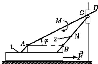
Стержень  $BC$  длины  $a$  шарнирно соединяет горизонтально скользящую платформу и вертикальный ползун  $C$ . Стержень  $AD = 2a$ , шарнирно закреплённый на платформе, опирается на ось  $C$  ползуна и скользит по ней,  $AB = a$ . Масса платформы равна  $m_1$ , стержня  $BC - m_2$ . К стержню  $AD$  приложен момент  $M$ , к платформе - горизонтальная сила  $F$ . Составить уравнение движения системы. За обобщенную координату принять  $\varphi$ .
