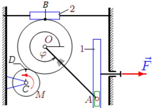
Цилиндр радиусом  $R$  находится в зацеплении с вращающимся диском радиусом  $r$  и горизонтально движущейся муфтой. Кривошип  $OA$  жестко соединен с цилиндром. Ползун  $A$ , шарнирно закрепленный на кривошипе, скользит в прорези кулисы;  $OA = a$ . К штоку кулисы приложена горизонтальная сила  $\vec{F}$ , к диску — момент  $M$ . Масса кулисы равна  $m_1$ . Масса муфты равна  $m_2$ . Составить уравнение движения системы. За обобщенную координату принять угол поворота кривошипа  $\varphi$ .
