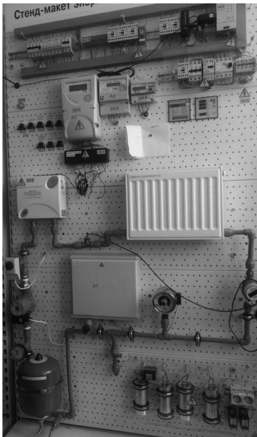
Рис. 1. Общая схема стенда, моделирующего энергосистему предприятия с элементами энергосбережения
