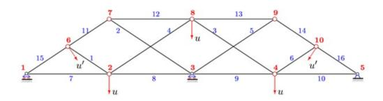
Расчет усилий для ферм с различным числом панелей показывает, что для четного числа панелей задача не имеет решения. Отдельное вычисление определителя системы уравнений равновесия показало, что в этом случае он равен нулю.
