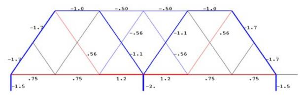
Численное решение задачи о распределении усилий по стержням фермы при n=6,  $\alpha=3$ м, h=6м. Синим цветом обозначены сжатые стержни, красным — растянутые. Усилий отнесены к нагрузке P
