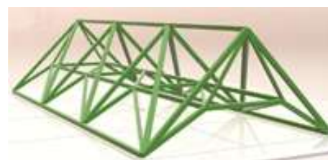
Рисунок 2 – Новые схемы пространственных ферм,
