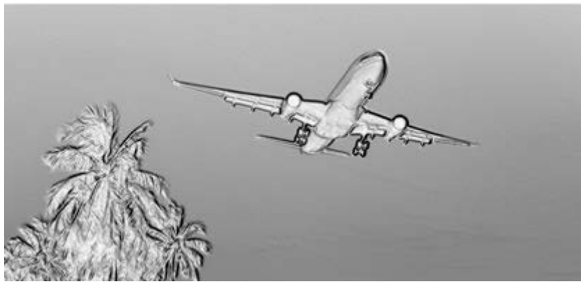
Рис. 4. Контур, полученный с помощью модифицированного фильтра [1] с маской (2) при d=1/10 . Время обработки 93.055
