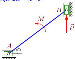
Ползуны  $A$  и  $B$  массой 4 кг каждый соединены стержнем длиной 1 м массой 5 кг. К стержню приложен момент  $M = 90$  Нм, к ползуну  $B$  — сила  $P = 15$  Н. Механизм расположен в горизонтальной плоскости. Найти угловое ускорение стержня при  $\sin \alpha = 3/5$ .
