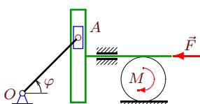
Кулисный механизм расположен в горизонтальной плоскости. Камень  $A$  массой 3 кг скользит в прорези кулисы. Длина кривошипа кулисного механизма  $OA = 5$  м. К штоку кулисы приложена сила  $F = 9$  Н, к цилиндру — момент  $M = 36$  Нм. Масса кулисы со штоком равна 10 кг. Радиус цилиндра 2 м. Найти угловое ускорение кривошипа при  $\varphi = \pi/4$ ,  $\dot{\varphi} = 4$   $\text{с}^{-1}$ .
