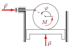
Цилиндр радиусом 1 м катится по поршню. Шток, движущийся в неподвижных направляющих, шарнирно прикреплен к ободу цилиндра. Момент  $M = 69$  Нм приложен к цилиндуру, сила  $P = 6$  Н — к поршню,  $F = 3$  Н — к штоку. Масса цилиндра равна 10 кг, поршня — 2 кг. Механизм расположен в горизонтальной плоскости. Найти угловое ускорение цилиндра при  $\varphi = \pi/2$ ,  $\dot{\varphi} = 2 \text{ c}^{-1}$ .
