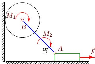
Брускок массой 9 кг, соединенный стержнем  $AB$  длиной 3 м с центром диска, скользит по поверхности. К диску радиуса 1 м приложен момент  $M_1 = 5$  Нм, к стержню — момент  $M_2 = 183$  Нм, к брускому силе  $F = 5$  Н. Масса диска равна 6 кг. Механизм расположен в горизонтальной плоскости. Найти угловое ускорение стержня при  $\sin \alpha = 0.6$ .
