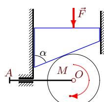
Цилиндр радиусом 0,5 м массой 3 кг шарнирно закреплен на штоке  $OA$ . Цилиндр катится по склонной поверхности клина. Клин движется в направляющих, перпендикулярных штоку. На клин массой 2 кг действует сила  $F = 152$  Н; масса штока 9 кг. К цилиндуру приложен момент  $M = 27$  Нм. Механизм расположен в горизонтальной плоскости. Найти ускорение клина при  $\alpha = \pi/3$ .
