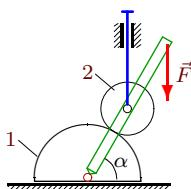
Полуцилиндр массой 10 кг радиусом 1 м скользит по гладкой плоскости. По его поверхности катится диск массой 10 кг радиусом 50 см, шарнирно закрепленный на штоке. На оси диска и полуцилиндра надета планка длиной 3 м, к концу которой приложена сила  $F = 45$  Н. Механизм расположен в горизонтальной плоскости. Найти угловое ускорение планки при  $\alpha = \pi/3$ .
