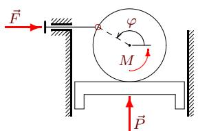
Цилиндр радиусом 1 м катится по поверхности поршня. Шток, движущийся в неподвижных направляющих, шарнирно прикреплен к ободу цилиндра. Момент  $M = 316$  Нм приложен к цилиндуру, сила  $P = 8$  Н — к поршню,  $F = 3$  Н — к штоку. Масса цилиндра равна 12 кг, штока — 7 кг. Механизм расположен в горизонтальной плоскости. Найти угловое ускорение цилиндра при  $\varphi = \pi/2$ ,  $\dot{\varphi} = 2 \text{ c}^{-1}$ .
