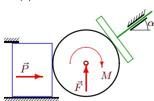
Цилиндр радиусом 1 м зажат между грузом, скользящим по гладкой поверхности, и поршнем. Механизм расположен в горизонтальной плоскости. К цилиндру приложены сила  $F = 8$  Н и момент  $M = 8$  Нм, к грузу — сила  $P = 20$  Н. Масса груза равна 1 кг, поршня — 3 кг;  $\sin \alpha = 4/5$ . Найти ускорение груза.
