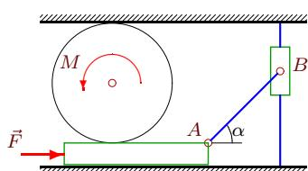
Стержень  $AB = 2$  м соединяет муфту, скользящую по вертикальному стержню, и горизонтально движущийся брускок. Цилиндр радиуса 2 м катится по плоскости и по бруски. Масса цилиндра равна 16 кг, муфты — 6 кг. Механизм расположен в горизонтальной плоскости;  $M = 8$  Нм,  $F = 58$  Н. Найти угловое ускорение стержня при  $\sin \alpha = 0.8$ .
