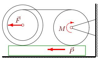
Блок с внешним радиусом 4 см и внутренним 2 см катится без проскальзывания по брускому, скользящему по гладкой горизонтальной поверхности. Радиус инерции блока 3 см. Масса цилиндра равна 4 кг, блока — 3 кг. К цилиндру приложен момент  $M = 0.96$  Нм, к оси блока — сила  $F = 210$  Н, к брускому — сила  $P = 70$  Н. Найти ускорение бруска.
