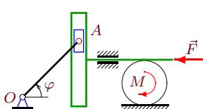
Кулисный механизм расположен в горизонтальной плоскости. Камень  $A$  скользит в прорези кулисы. Длина кривошипа кулисного механизма  $OA = 5$  м. К штоку кулисы приложена сила  $F = 5$  Н, к цилинду — момент  $M = 20$  Нм. Масса кулисы со штоком равна 5 кг, масса кривошипа — 6 кг. Радиус цилиндра 2 м. Найти угловое ускорение кривошипа при  $\varphi = \pi/4$ ,  $\dot{\varphi} = 3 \text{ c}^{-1}$ .
