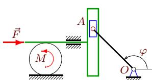
Кулисный механизм расположен в горизонтальной плоскости. Камень  $A$  скользит в прорези кулисы. Длина кривошипа кулисного механизма  $OA = 5$  м. К штоку кулисы приложена сила  $F = 7$  Н, к цилиндуру — момент  $M = 28$  Нм. Масса кулисы со штоком равна 3 кг, масса однородного цилиндра — 16 кг. Радиус цилиндра 2 м. Найти угловое ускорение кривошипа при  $\varphi = 3\pi/4$ ,  $\dot{\varphi} = 3 \text{ c}^{-1}$ .
