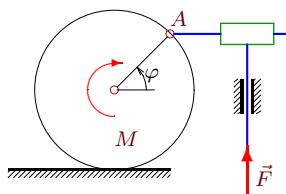
Цилиндр радиусом 2 м и массой 8 кг имеет на ободе шарнир, к которому присоединен стержень массой 10 кг, скользящий в муфте, жестко скрепленной с штоком. Шток движется в направляющих, перпендикулярных поверхности, по которой катится цилиндр. К диску приложен момент  $M = 108$  Нм, к штоку — сила  $F = 10$  Н. Механизм расположен в горизонтальной плоскости. Найти угловое ускорение цилиндра при  $\sin \varphi = 0.8$ ,  $\dot{\varphi} = 2 \text{ c}^{-1}$ .
