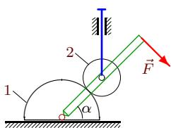
Полуцилиндр массой 10 кг радиусом 1 м скользит по гладкой плоскости. По его поверхности катится диск массой 10 кг радиусом 50 см, шарнирно закрепленный на штоке. Оси диска и полуцилиндра соединяют планка длиной 3 м, к концу которой перпендикулярно ей приложена сила  $F = 45$  Н. Механизм расположен в горизонтальной плоскости. Найти угловое ускорение планки при  $\alpha = \pi/4$ .
