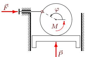
Цилиндр радиусом 1 м катится по поверхности поршня. Шток, движущийся в неподвижных направляющих, шарнирно прикреплен к ободу цилиндра. Момент  $M = 239$  Нм приложен к цилиндру, сила  $P = 18$  Н — к поршню,  $F = 3$  Н — к штоку. Масса цилиндра равна 14 кг, штока — 7 кг. Механизм расположен в горизонтальной плоскости. Найти угловое ускорение цилиндра при  $\varphi = \pi/2$ ,  $\dot{\varphi} = 1 \text{ c}^{-1}$ .
