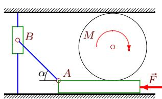
Стержень  $AB = 2$  м соединяет муфту, скользящую по вертикальному стержню, и горизонтально движущийся брускок. Цилиндр радиуса 2 м катится по плоскости и по брускому. Масса цилиндра равна 24 кг, муфты — 9 кг. Механизм расположен в горизонтальной плоскости;  $M = 4$  Нм,  $F = 179$  Н. Найти угловое ускорение стержня при  $\sin \alpha = 0.8$ .
