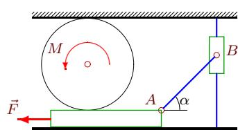
Стержень  $AB = 2$  м соединяет муфту, скользящую по вертикальному стержню, и горизонтально движущийся бруск. Цилиндр радиуса 2 м катится по плоскости и по бруsku. Масса бруска равна 1 кг, муфты — 1 кг. Механизм расположен в горизонтальной плоскости;  $M = 8$  Нм,  $F = 12$  Н. Найти угловое ускорение стержня при  $\sin \alpha = 0.8$ .
