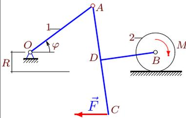
Стержни  $DB$  и  $AC$ , жестко скрепленные под прямым углом, шарнирно соединены с кривошипом  $OA$  и цилиндром радиусом  $R$ . Масса кривошипа  $m_1$ , масса цилиндра —  $m_2$ . К точке  $C$  приложена горизонтальная сила  $\vec{F}$ , к цилиндру — момент  $M$ . Дано:  $OA = a\sqrt{2}$ ,  $AD = DC = DB = a$ . Составить уравнение движения системы. За обобщенную координату принять угол поворота кривошипа  $\varphi$ .
