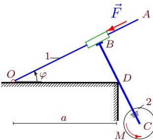
К муфте  $B$ , скользящей по кривошипу  $OA$ , под прямым углом жестко прикреплен стержень  $BC$ . На конце стержня расположен диск радиусом  $R$ , образуя со стержнем одно тело. Стержень  $BC$  скользит без отрыва по гладкому углу. Масса кривошипа  $m_1$ , масса диска —  $m_2$ . К муфте вдоль кривошипа приложена сила  $\vec{F}$ , к диску — момент  $M$ . Дано:  $OA = b$ ,  $BC = c$ . Составить уравнение движения системы. За обобщенную координату принять угол поворота кривошипа  $\varphi$ .
