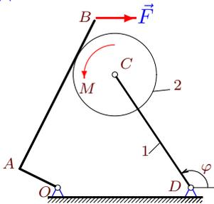
Уголок  $OAB$  из двух жестко скрепленных под прямым углом стержней вращается на шарнире  $O$ . Цилиндр радиусом  $R$ , шарнирно закрепленный на конце кривошипа  $CD$ , катится по уголку.  $OA = R$ ,  $AB = l$ ,  $OD = DC = b$ . Масса кривошипа  $m_1$ , масса цилиндра —  $m_2$ . К уголку приложена горизонтальная сила  $\vec{F}$ , к цилиндру — момент  $M$ . Составить уравнение движения системы. За обобщенную координату принять угол поворота кривошипа  $\varphi$ .
