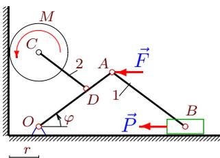
Механизм состоит из трех шарнирно соединенных стержней, ползуна и цилиндра радиусом  $r$ . Цилиндр катится по вертикальной плоскости, ползун скользит горизонтально;  $OA = AB = a$ ,  $CD = OD = b$ . К шарниру  $A$  и к ползуну приложены горизонтальные силы  $\vec{F}$  и  $\vec{P}$ , к цилиндру — момент  $M$ . Масса стержня  $AB$  равна  $m_1$ , стержня  $DC$  —  $m_2$ . Составить уравнение движения системы. За обобщенную координату принять угол поворота кривошипа  $\varphi$ .
