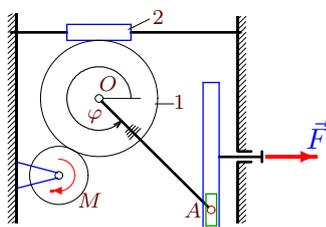
Цилиндр радиусом  $R$ , массой  $m_1$ , находится в зацеплении с вращающимся диском радиусом  $r$  и горизонтально движущейся муфтой. Кривошип  $OA$  жестко соединен с цилиндром. Ползун  $A$ , шарнирно закрепленный на кривошипе, скользит в прорези кулисы;  $OA = a$ . К штоку кулисы приложена горизонтальная сила  $\vec{F}$ , к диску — момент  $M$ . Масса муфты равна  $m_2$ . Составить уравнение движения системы. За обобщенную координату принять угол поворота кривошипа  $\varphi$ .
