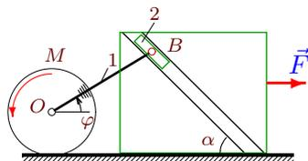
Цилиндр радиусом  $R$  катится без проскальзывания по горизонтальной поверхности. Стержень  $OB$  массой  $m_1$  жестко соединен с цилиндром. Ползун  $B$ , шарнирно закрепленный на кривошипе, скользит в наклонной прорези призмы, движущейся по гладкой плоскости;  $OB = a$ . Масса ползуна равна  $m_2$ . Составить уравнение движения системы. За обобщенную координату принять угол поворота кривошипа  $\varphi$ .
