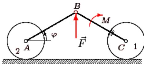
Два диска массой  $m_1$  и  $m_2$  радиуса  $R$  шарнирно соединены невесомыми стержнями  $AB = BC = a$ . Стержень  $BC$  жестко скреплен с диском 1. Момент  $M$  приложен к стержню  $BC$ , вертикальная сила  $F$  — к шарниру  $B$ . Составить уравнение движения системы. За обобщенную координату принять  $\varphi$ .
