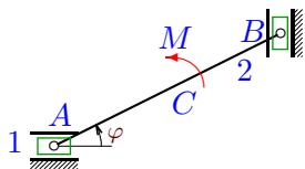
Горизонтально движущийся ползун  $A$  массой  $m_1$  соединен с вертикально движущимся невесомым ползуном  $B$ . Масса однородного стержня  $AB$  равна  $m_2$ .  $AB = a$ . К стержню приложен момент  $M$ . Составить уравнение движения системы. За обобщенную координату принять  $\varphi$ .
