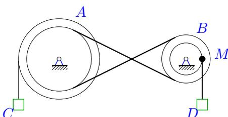
Механическая передача состоит из шкива  $A$  ( $R_A = 25$  см,  $r_A = 15$  см), шкива  $B$  ( $R_B = 10$  см,  $r_B = 8$  см), соединенных ремнем, и двух грузов  $C$  и  $D$ . Груз  $D$  опускается с переменной скоростью  $V_D = 32t^4$  см/с. Определить скорость груза  $C$  через 1 с после начала движения.
