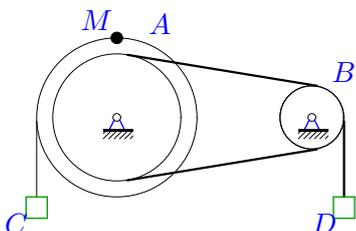
Механическая передача состоит из шкива  $A$  ( $R_A = 20$  см,  $r_A = 16$  см), шкива  $B$  ( $R_B = 15$  см,  $r_B = 5$  см), соединенных ремнем, и двух грузов  $C$  и  $D$ . Груз  $D$  опускается с переменной скоростью  $V_D = 20t^4$  см/с. Определить скорость груза  $C$  через 1 с после начала движения.
