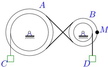
Движение шкива  $A$  ( $R_A = 25$  см,  $r_A = 15$  см) передается ремнем шкиву  $B$  ( $R_B = 10$  см,  $r_B = 8$  см). Скорость груза  $C$  увеличивается  $V_C = 24t^3$  см/с. Определить скорость груза  $D$  через 1 с после начала движения.
