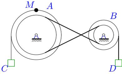
Механическая передача состоит из шкива  $A$  ( $R_A = 20$  см,  $r_A = 16$  см), шкива  $B$  ( $R_B = 15$  см,  $r_B = 5$  см), соединенных ремнем, и двух грузов  $C$  и  $D$ . Груз  $D$  опускается с переменной скоростью  $V_D = 60t^4$  см/с. Определить скорость груза  $C$  через 1 с после начала движения.
