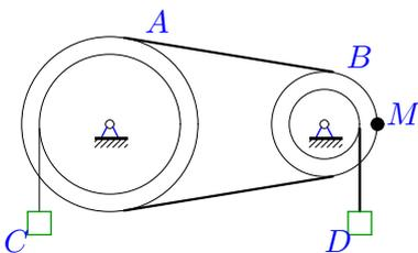
Движение шкива  $A$  ( $R_A = 20$  см,  $r_A = 16$  см) передается ремнем шкиву  $B$  ( $R_B = 15$  см,  $r_B = 5$  см). Скорость груза  $C$  увеличивается  $V_C = 15t^3$  см/с. Определить скорость груза  $D$  через 1 с после начала движения.
