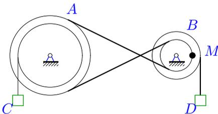
Шкив  $A$  ( $R_A = 25$  см,  $r_A = 15$  см) соединен со шкивом  $B$  ( $R_B = 10$  см,  $r_B = 8$  см) ремнем. Груз  $C$  опускается с переменной скоростью  $V_C = 20t^2$  см/с. Определить скорость груза  $D$  через 1 с после начала движения.
