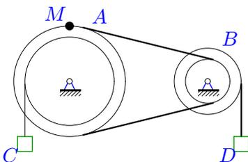
Движение шкива  $A$  ( $R_A = 25$  см,  $r_A = 15$  см) передается ремнем шкиву  $B$  ( $R_B = 10$  см,  $r_B = 8$  см). Скорость груза  $C$  увеличивается  $V_C = 30t^3$  см/с. Определить скорость груза  $D$  через 1 с после начала движения.
