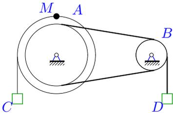
Механическая передача состоит из шкива  $A$  ( $R_A = 40$  см,  $r_A = 30$  см), шкива  $B$  ( $R_B = 25$  см,  $r_B = 10$  см), соединенных ремнем, и двух грузов  $C$  и  $D$ . Груз  $D$  опускается с переменной скоростью  $V_D = 40t^4$  см/с. Определить скорость груза  $C$  через 1 с после начала движения.
