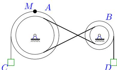
Механическая передача состоит из шкива  $A$  ( $R_A = 40$  см,  $r_A = 30$  см), шкива  $B$  ( $R_B = 25$  см,  $r_B = 10$  см), соединенных ремнем, и двух грузов  $C$  и  $D$ . Груз  $D$  опускается с переменной скоростью  $V_D = 100t^4$  см/с. Определить скорость груза  $C$  через 1 с после начала движения.
