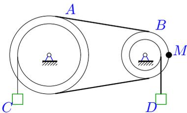
Шкив  $A$  ( $R_A = 25$  см,  $r_A = 15$  см) соединен со шкивом  $B$  ( $R_B = 10$  см,  $r_B = 8$  см) ремнем. Груз  $C$  опускается с переменной скоростью  $V_C = 16t^2$  см/с. Определить скорость груза  $D$  через 1 с после начала движения.
