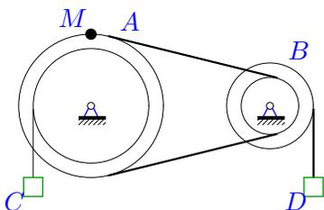
Шкив  $A$  ( $R_A = 20$  см,  $r_A = 16$  см) соединен со шкивом  $B$  ( $R_B = 15$  см,  $r_B = 5$  см) ремнем. Груз  $C$  опускается с переменной скоростью  $V_C = 30t^2$  см/с. Определить скорость груза  $D$  через 1 с после начала движения.
