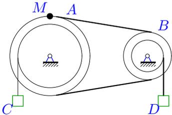
Движение шкива  $A$  ( $R_A = 30$  см,  $r_A = 20$  см) передается ремнем шкиву  $B$  ( $R_B = 15$  см,  $r_B = 6$  см). Скорость груза  $C$  увеличивается  $V_C = 18t^3$  см/с. Определить скорость груза  $D$  через 1 с после начала движения.
