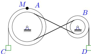
Движение шкива  $A$  ( $R_A = 25$  см,  $r_A = 15$  см) передается ремнем шкиву  $B$  ( $R_B = 10$  см,  $r_B = 8$  см). Скорость груза  $C$  увеличивается  $V_C = 30t^3$  см/с. Определить скорость груза  $D$  через 1 с после начала движения.
