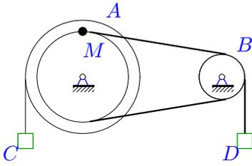
Движение шкива  $A$  ( $R_A = 25$  см,  $r_A = 15$  см) передается ремнем шкиву  $B$  ( $R_B = 10$  см,  $r_B = 8$  см). Скорость груза  $C$  увеличивается  $V_C = 24t^3$  см/с. Определить скорость груза  $D$  через 1 с после начала движения.
