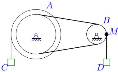
Механическая передача состоит из шкива  $A$  ( $R_A = 25$  см,  $r_A = 15$  см), шкива  $B$  ( $R_B = 10$  см,  $r_B = 8$  см), соединенных ремнем, и двух грузов  $C$  и  $D$ . Груз  $D$  опускается с переменной скоростью  $V_D = 32t^4$  см/с. Определить скорость груза  $C$  через 1 с после начала движения.
