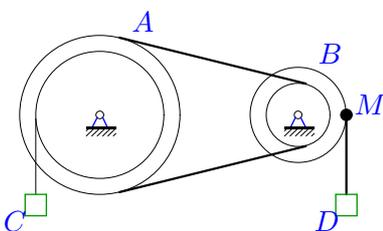
Шкив  $A$  ( $R_A = 30$  см,  $r_A = 20$  см) соединен со шкивом  $B$  ( $R_B = 15$  см,  $r_B = 6$  см) ремнем. Груз  $C$  опускается с переменной скоростью  $V_C = 30t^2$  см/с. Определить скорость груза  $D$  через 1 с после начала движения.
