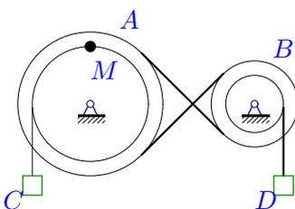
Движение шкива  $A$  ( $R_A = 40$  см,  $r_A = 30$  см) передается ремнем шкиву  $B$  ( $R_B = 25$  см,  $r_B = 10$  см). Скорость груза  $C$  увеличивается  $V_C = 30t^3$  см/с. Определить скорость груза  $D$  через 1 с после начала движения.
