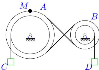
Движение шкива  $A$  ( $R_A = 20$  см,  $r_A = 16$  см) передается ремнем шкиву  $B$  ( $R_B = 15$  см,  $r_B = 5$  см). Скорость груза  $C$  увеличивается  $V_C = 15t^3$  см/с. Определить скорость груза  $D$  через 1 с после начала движения.
