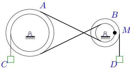
Шкив  $A$  ( $R_A = 30$  см,  $r_A = 20$  см) соединен со шкивом  $B$  ( $R_B = 15$  см,  $r_B = 6$  см) ремнем. Груз  $C$  опускается с переменной скоростью  $V_C = 30t^2$  см/с. Определить скорость груза  $D$  через 1 с после начала движения.
