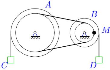
Движение шкива  $A$  ( $R_A = 25$  см,  $r_A = 15$  см) передается ремнем шкиву  $B$  ( $R_B = 10$  см,  $r_B = 8$  см). Скорость груза  $C$  увеличивается  $V_C = 30t^3$  см/с. Определить скорость груза  $D$  через 1 с после начала движения.
