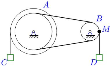
Механическая передача состоит из шкива  $A$  ( $R_A = 20$  см,  $r_A = 16$  см), шкива  $B$  ( $R_B = 15$  см,  $r_B = 5$  см), соединенных ремнем, и двух грузов  $C$  и  $D$ . Груз  $D$  опускается с переменной скоростью  $V_D = 20t^4$  см/с. Определить скорость груза  $C$  через 1 с после начала движения.
