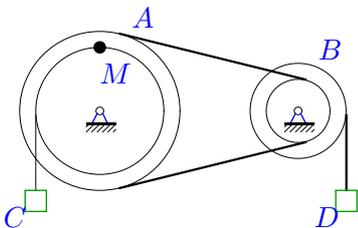
Шкив  $A$  ( $R_A = 40$  см,  $r_A = 30$  см) соединен со шкивом  $B$  ( $R_B = 25$  см,  $r_B = 10$  см) ремнем. Груз  $C$  опускается с переменной скоростью  $V_C = 50t^2$  см/с. Определить скорость груза  $D$  через 1 с после начала движения.
