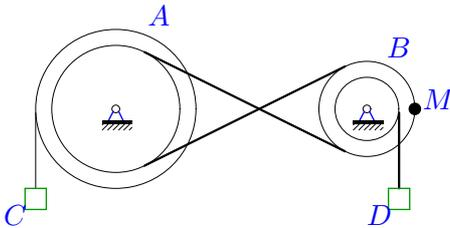
Движение шкива  $A$  ( $R_A = 20$  см,  $r_A = 16$  см) передается ремнем шкиву  $B$  ( $R_B = 15$  см,  $r_B = 5$  см). Скорость груза  $C$  увеличивается  $V_C = 15t^3$  см/с. Определить скорость груза  $D$  через 1 с после начала движения.
