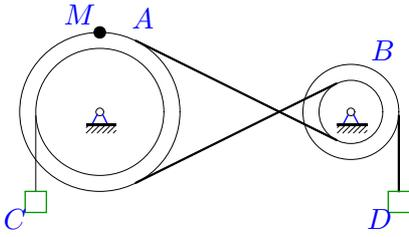
Механическая передача состоит из шкива  $A$  ( $R_A = 40$  см,  $r_A = 30$  см), шкива  $B$  ( $R_B = 25$  см,  $r_B = 10$  см), соединенных ремнем, и двух грузов  $C$  и  $D$ . Груз  $D$  опускается с переменной скоростью  $V_D = 100t^4$  см/с. Определить скорость груза  $C$  через 1 с после начала движения.
