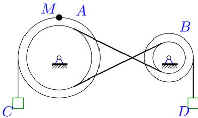
Движение шкива  $A$  ( $R_A = 30$  см,  $r_A = 20$  см) передается ремнем шкиву  $B$  ( $R_B = 15$  см,  $r_B = 6$  см). Скорость груза  $C$  увеличивается  $V_C = 45t^3$  см/с. Определить скорость груза  $D$  через 1 с после начала движения.
