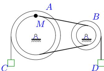
Движение шкива  $A$  ( $R_A = 40$  см,  $r_A = 30$  см) передается ремнем шкиву  $B$  ( $R_B = 25$  см,  $r_B = 10$  см). Скорость груза  $C$  увеличивается  $V_C = 75t^3$  см/с. Определить скорость груза  $D$  через 1 с после начала движения.
