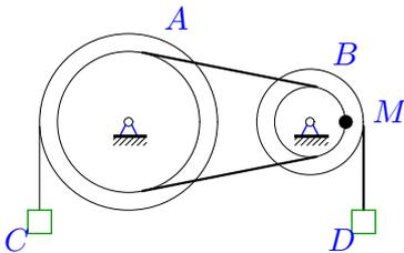
Движение шкива  $A$  ( $R_A = 40$  см,  $r_A = 30$  см) передается ремнем шкиву  $B$  ( $R_B = 25$  см,  $r_B = 10$  см). Скорость груза  $C$  увеличивается  $V_C = 75t^3$  см/с. Определить скорость груза  $D$  через 1 с после начала движения.
