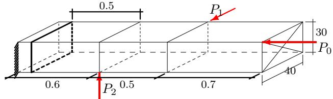
Дано:  $a = 0.5\text{м}$ ,  $b = 40\text{см}$ ,  $h = 30\text{см}$ ,  $l_1 = 0.7\text{м}$ ,  $l_2 = 0.5\text{м}$ ,  $l_3 = 0.6\text{м}$ ,  $P_0 = 10\text{kH}$ ,  $P_1 = 20\text{kH}$ ,  $P_2 = 32\text{kH}$ ,
