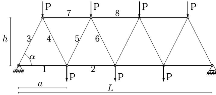
В силу симметрии задачи, рассмотрим одну половину фермы. Определим усилия в сжатых стержнях:  $N_3 = -3.5P/\sin\alpha$ ,  $N_5 = -1.5P/\sin\alpha$ ,  $N_7 = -6P/\operatorname{tg}\alpha$ ,  $N_8 = -8P/\operatorname{tg}\alpha$ .
