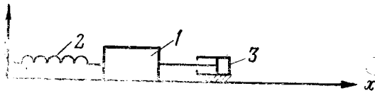
Рис. 5.1. Линейный осциллятор: 1 — масса; 2 — пружина; 3 — демпфер
