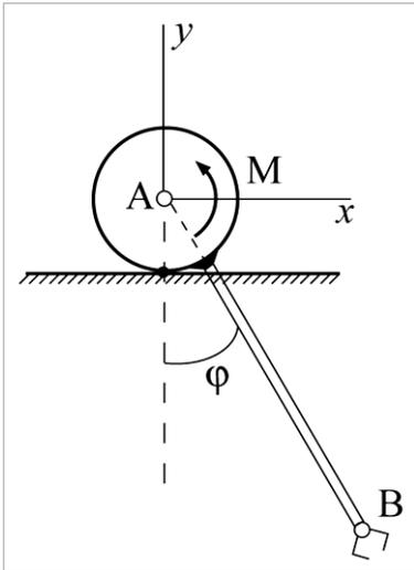
Одностепенный манипулятор работает в вертикальной плоскости. Известно, что масса колеса  $m_1$ , его радиус  $r$ ; масса схвата В равна  $m_2$ ,  $AB=3r$ ,  $M_z = M_{0z} + U_z - \mu \dot{\varphi}$ , управление:  $U_z = -N(\varphi - \varphi_0)$ ,  $\mu, N$  – константы. За обобщенную координату принять угол  $\varphi$ .
