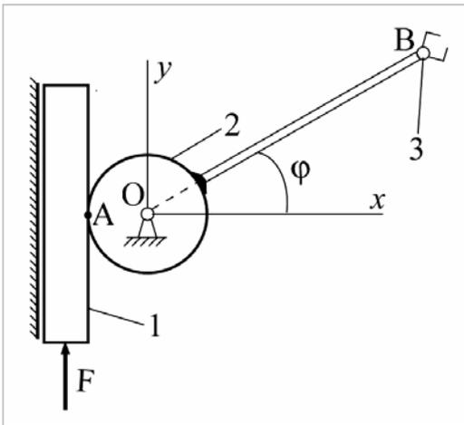
Одностепенной манипулятор работает в вертикальной плоскости. Известно, что масса рейки  $m_1$ , масса колеса  $m_2$ , его радиус  $r$ , масса схвата В равна  $m_3$ ,  $OB=3r$ , сила:  $F_y = F_{0y} + U_y - \mu V_{Ay}$ , управление  $U_y = N(\varphi - \varphi_0)$ ,  $\mu, N$  – константы. За обобщенную координату принять угол  $\varphi$ .
