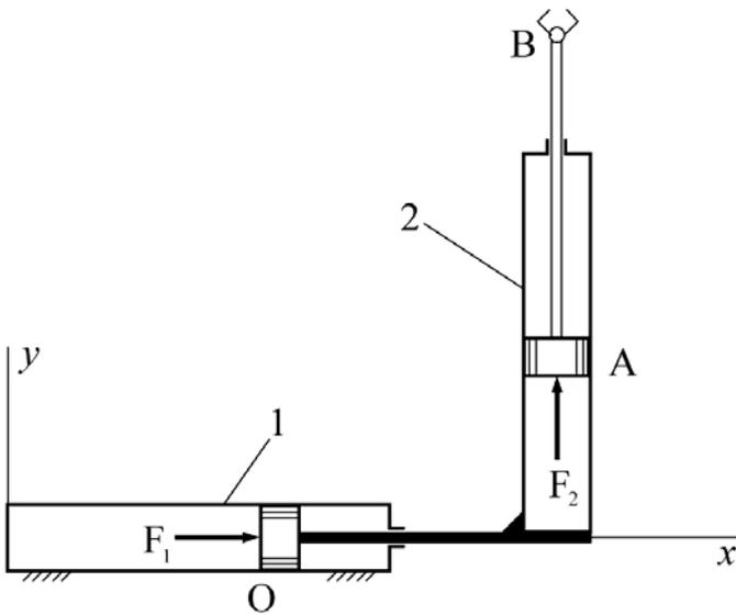
Манипулятор работает в горизонтальной плоскости. Известно, что масса поршня А, штока АВ и схвата В равна  $m_1$ ; масса поршня О, штока и цилиндра 2 равна  $m_2$ ;  $F_{1x} = U_x - a_1 V_{0x} - b_1 x$ ,  $U_x$  – управление,  $F_{2y} = -a_2 V_{Ay} - b_2 y$ ,  $a_1, a_2, b_1, b_2$  – константы. За обобщенные принять координаты  $x, y$  поршня О и А соответственно, отсчитываемые от положения равновесия.
