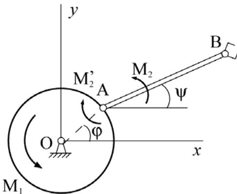
Манипулятор типа «Скара» работает в вертикальной плоскости. Известно, что масса диска  $m_1$ , его радиус  $r$ ; масса схвата В  $m_2$ , длина звена АВ равна  $2r$ , его массой пренебречь; моменты:  $M_{1z} = M_{01z} + U_z - \mu_1 \dot{\varphi}$ ,  $M_{2z} = M_{02z} - \mu_2 \dot{\psi}$ ,  $M'_{2z} = -M_{2z}$ ,  $\mu_1, \mu_2, N$  – константы; управление  $U_z = -N(\varphi - \varphi_0)$ . За обобщенные координаты принять углы  $\varphi$  и  $\psi$ .
