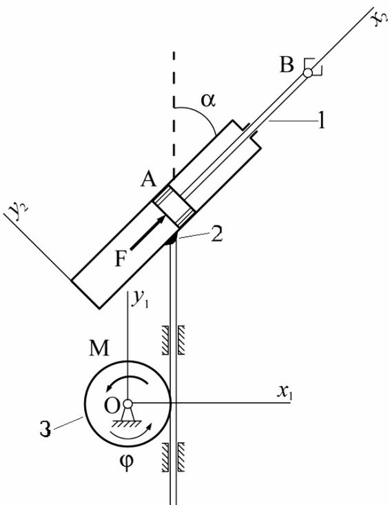
Манипулятор работает в горизонтальной плоскости. Известно, что масса поршня А, штока АВ и схвата В равна  $m_1$ , масса цилиндра и рейки -  $m_2$ ; масса колеса -  $m_3$ , его радиус  $r$ ;  $F_{x_2} = -bx_2$ ,  $M_z = U_z - a\dot{\varphi}$ ; управление  $U_z = -N\varphi$ ,  $a, b, N$  - константы,  $\alpha$  - угол между осями  $x_1, x_2$ . За обобщенные координаты принять координату  $x_2$  поршня А и угол  $\varphi$  поворота колеса, которые отсчитываются от положения равновесия.
