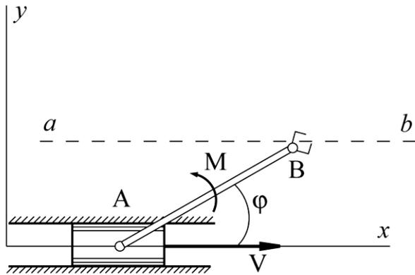
Манипулятор работает в вертикальной плоскости. Известно, что поршень А движется по оси  $x$  с постоянной скоростью  $V$ , а схват В движется вблизи линии  $ab$ . Масса схвата равна  $m$ ,  $AB=l$ , момент:  $M_z = M_{0z} + U_z - \mu \dot{\varphi}$ , управление  $U_z = -N(\varphi - \varphi_0)$ ,  $\mu, N$  – константы. За обобщенную координату принять угол  $\varphi$ .
