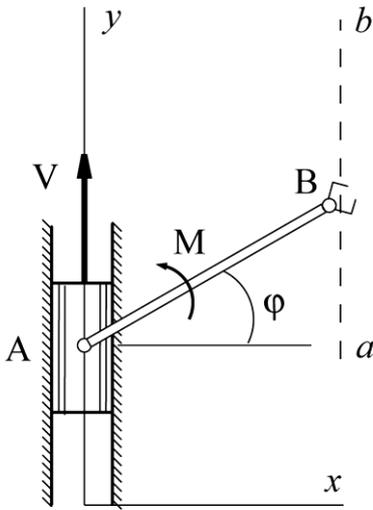
Манипулятор работает в вертикальной плоскости. Известно, что поршень А движется по оси  $y$  с постоянной скоростью  $V$ , а схват В движется вблизи линии  $ab$ . Масса схвата  $m$ ,  $AB = l$ , момент:  $M_z = M_{0z} + U_z - \mu \dot{\varphi}$ , управление  $U_z = -N(\varphi - \varphi_0)$ ,  $\mu, N$  – константы. За обобщенную координату принять угол  $\varphi$ .
