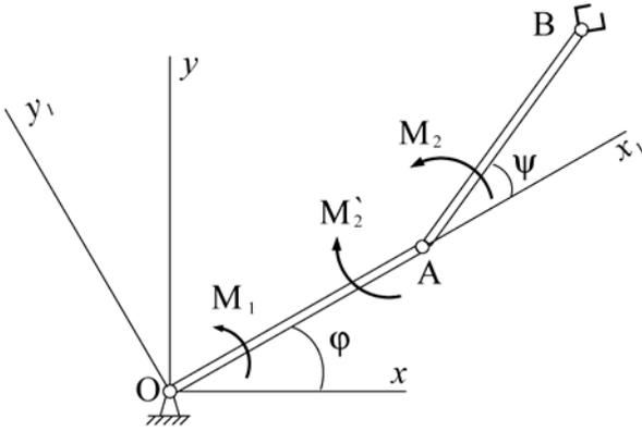
Манипулятор типа «Скара» работает в горизонтальной плоскости. Известно, что масса схвата В  $m_1$ , момент инерции звена ОА -  $I_{0z}$ , его длина  $l$  равна длине невесомого звена АВ; моменты:  $M_{1z} = M_{01z} - \mu_1 \dot{\varphi}$ ,  $M_{2z} = M_{02z} + U_z - \mu_2 \dot{\psi}$ , управление  $U_z = -N(A\varphi + B(\psi - \psi_0))$ ,  $\mu_1, \mu_2, N$  - константы. За обобщенные координаты при-
