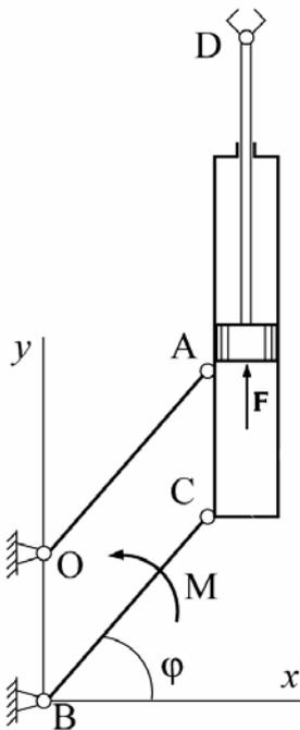
Манипулятор работает в вертикальной плоскости. Известно, что масса поршня A вместе со штоком AD и схватом D равна  $m_1$ , масса цилиндра  $m_2$ , звенья OA и BC длины  $l$ , их массой пренебречь;  $OB=AC$ ;  $F_y = F_{0y} - a_1\dot{y} - b_1y$ ,  $M_z = M_{0z} + U_z - a_2\dot{\varphi}$ , управление  $U_z = -N(\varphi - \varphi_0)$ ,  $a_1, a_2, b_1, N$  – константы. За обобщенные координаты принять угол  $\varphi$  и координату  $y$  поршня A, отсчитываемую от положения равновесия.
