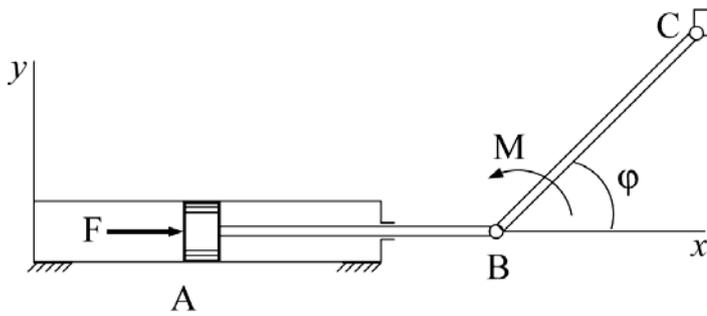
Манипулятор работает в вертикальной плоскости. Известно, что масса поршня А вместе со штоком АВ равна  $m_1$ , масса схвата С равна  $m_2$ , длина невесомого звена  $BC = l$ ,  $F_x = -a_1\dot{x} - b_1x$ , момент:  $M_z = M_{0z} + U_z - a_2\dot{\varphi}$ , управление  $U_z = -N(\varphi - \varphi_0)$ ,
