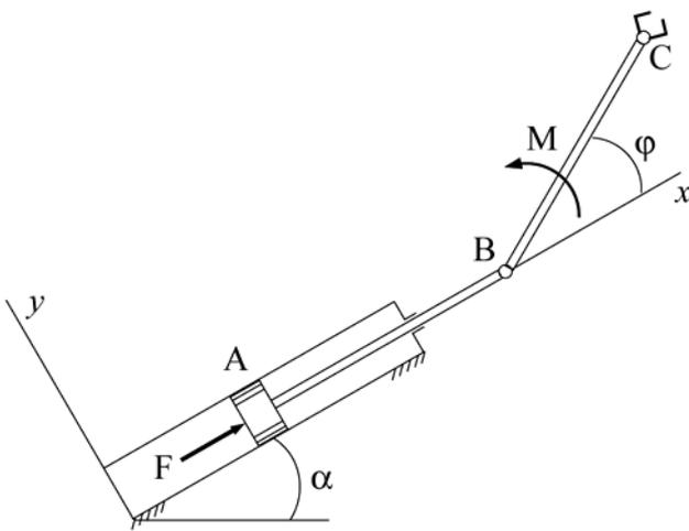
Манипулятор работает в вертикальной плоскости. Известно, что масса поршня А вместе со штоком  $m_1$ , масса схвата С  $m_2$ , длина невесомого звена  $BC = l$ .  $\alpha$  – угол наклона цилиндра к горизонту,  $F_x = F_{0x} - a \dot{x} - b x$ ,  $M_z = M_{0z} + U_z$ ,  $a, b$  константы,  $U_z = -N(\varphi - \varphi_0)$  управление. За обобщенные координаты принять угол  $\varphi$  и координату  $x$  поршня, отсчитываемую от положения равновесия.
