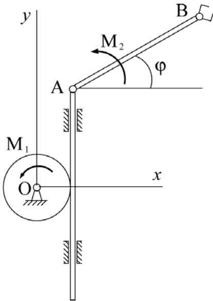
Манипулятор работает в вертикальной плоскости. Известно, что масса колеса  $m_1$ , его радиус  $r$ , масса схвата  $m_2$ , длина звена  $AB = l$ , его массой и массой рейки пренебречь; моменты  $M_{1z} = M_{01z} - a_1 \omega_{1z}$ ,  $M_{2z} = M_{02z} + U_z - a_2 \dot{\varphi}$ , управление  $U_z = -N(\varphi - \varphi_0)$ ,  $a_1, a_2, N$  – константы. За обобщенные координаты принять угол  $\varphi$  и координату  $y$  точки  $A$ , отсчитываемую от положения равновесия.
