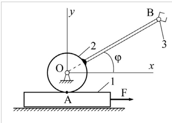
Одностепенный манипулятор работает в вертикальной плоскости. Известно, что масса рейки  $m_1$ , масса колеса  $m_2$ , его радиус  $r$ , масса схвата  $m_3$ ,  $OB=3r$ ,  $F_x = F_{0x} + U_x - \mu V_{Ax}$ , управление  $U_x = -N(\varphi - \varphi_0)$ ,  $\mu, N$  – константы. За обобщенную координату принять угол  $\varphi$ .
