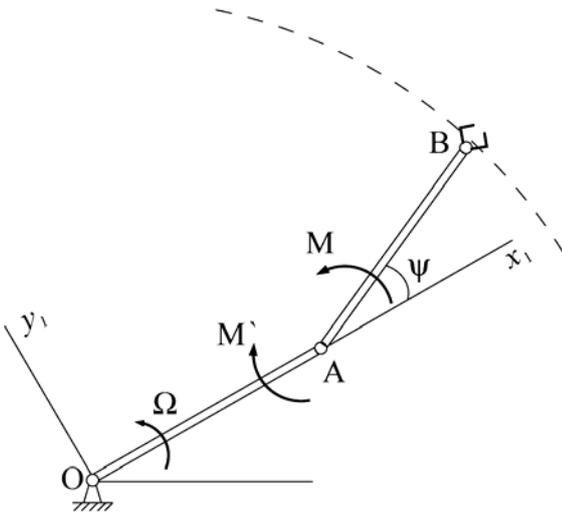
Манипулятор типа «Скара» работает в горизонтальной плоскости. Известно, что звено OA вращается с постоянной угловой скоростью  $\Omega$ , а схват В движется вблизи круговой траектории, радиус которой отвечает длине звеньев OA и AB и углу  $\psi_0$ . Масса схвата В равна  $m$ ,  $OA=AB=l$ , момент:  $M_z = M_{0z} + U_z - \mu\dot{\psi}$ ,  $U_z = -N(\psi - \psi_0)$  - управление,  $\mu, N$  - константы. За обобщенную координату принять угол  $\psi$ .
