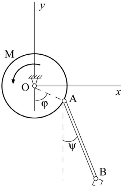
Манипулятор типа «Скара» работает в вертикальной плоскости. Известно, что масса диска  $m_1$ , его радиус  $r$ ; масса схвата В  $m_2$ , длина звена АВ равна  $2r$ , его массой пренебречь;  $M_z = M_{0z} + U_z - \mu \dot{\varphi}$ , управление  $U_z = -N(\varphi - \varphi_0)$ ,  $\mu, N$  - константы. За обобщенные координаты принять углы  $\varphi$  и  $\psi$ .
