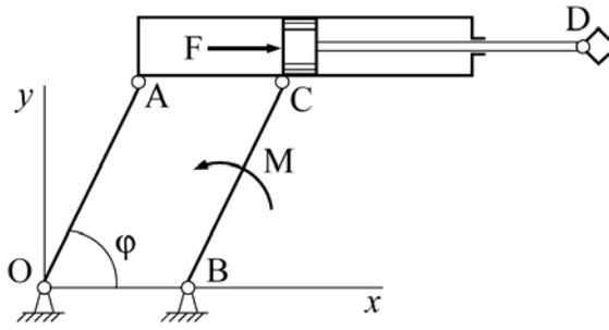
Манипулятор работает в вертикальной плоскости. Известно, что масса поршня вместе со штоком и схватом  $m_1$ , масса цилиндра  $m_2$ , звенья OA и BC длины  $l$ , их массой пренебречь;  $OB=AC$ ;  $F_x = -a_1\dot{x} - b_1x$ , момент:  $M_z = M_{0z} + U_z - a_2\dot{\varphi}$ , управление:  $U_z = -N(\varphi - \varphi_0)$ ,  $a_1, a_2, b_1, N$  – константы. За
