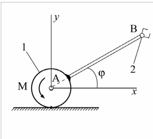
Одностепенной манипулятор работает в вертикальной плоскости. Известно, что масса колеса  $m_1$ , его радиус  $r$ ; масса схвата  $m_2$ ,  $AB=3r$ ,  $M_z = M_{0z} + U_z - \mu \dot{\varphi}$ , управление:  $U_z = -N(\varphi - \varphi_0)$ ,  $\mu, N$  – константы. За обобщенную координату принять угол  $\varphi$ .
