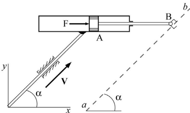
Манипулятор работает в горизонтальной плоскости. Известно, что цилиндр движется с постоянной скоростью  $V$ , направленной под углом  $\alpha$  к оси  $x$ . Схват В движется вблизи линии  $ab$ . Масса поршня А вместе со штоком АВ и схватом В равна  $m$ ,  $F = U_x - ax$ , управление  $U_x = -Nx$ ,  $a, N$  – константы. За обобщенную координату принять координату  $x$ , отсчитываемую от
