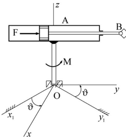
Манипулятор работает в горизонтальной плоскости. Известно, что масса схвата В равна  $m_1$ , момент инерции цилиндра  $I_{0z}$ , сила:  $F_y = F_{0y} - a_1 \dot{y} - b_1 y$ , момент:  $M_z = U_z - a_2 \dot{\vartheta}$ ,  $U_z$  – управление,  $a_1, a_2, b_1$  – константы. За обобщенные координаты принять координату  $y$  захвата В и угол  $\vartheta$ , отсчитываемый от положения равновесия. Массой поршня и штока пренебречь.
