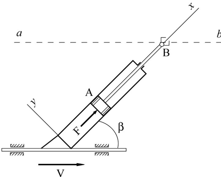
Манипулятор работает в горизонтальной плоскости. Известно, что цилиндр движется с постоянной скоростью  $V$ , направленной под углом  $\beta$  к оси  $x$ . Схват В движется вблизи линии  $ab$ . Масса поршня А, штока АВ и схвата В равна  $m$ , сила  $F = U_x - a\dot{x}$ , управление  $U_x = -Nx$ ,  $a, N$  – константы. За обобщенную координату принять координату  $x$ , отсчитываемую от положения схвата В на траектории  $ab$ .
