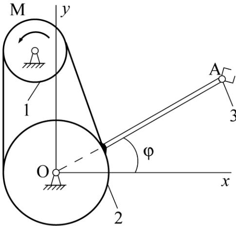
Одностепенный манипулятор работает в вертикальной плоскости. Дано:  $m_1, m_2, m_3, r, R, OA=l$ . Момент двигателя:  $M_z = M_{0z} + U_z - \mu \omega_{1z}$ , управление:  $U_z = -N(\varphi - \varphi_0)$ ,  $\mu, N$  – константы. За обобщенную координату принять угол  $\varphi$ .
