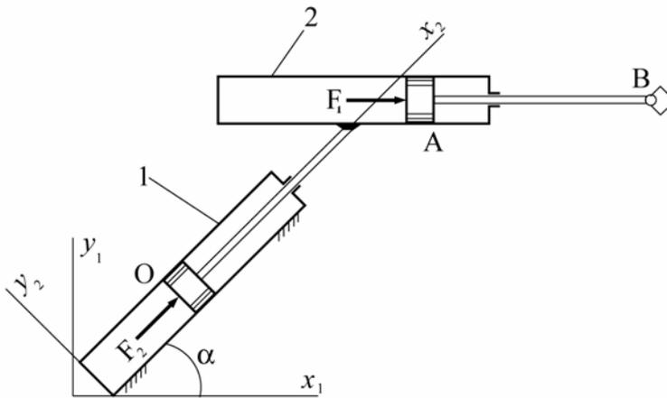
Манипулятор работает в горизонтальной плоскости. Известно, что масса поршня А вместе со штоком АВ и схватом В равна  $m_1$ , масса поршня О, штока и цилиндра 2 -  $m_2$ ;  $F_{1x_1} = -bx_1$ ,  $F_{2x_2} = U_{x_2} - a\dot{x}_2$ , управление  $U_{x_2} = -Nx_2$ ,  $a, b, N$  константы. Угол между осями цилиндров  $\alpha$ . За обобщенные принять координаты  $x_1, x_2$  поршней А и О соответственно, отсчитываемые от положения равновесия.
