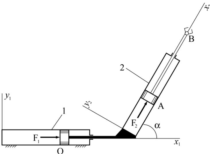
Манипулятор работает в горизонтальной плоскости. Известно, что масса поршня А, штока АВ и схвата В равна  $m_2$ ; масса поршня О, штока и цилиндра 2 равна  $m_1$ ;  $F_{1x_1} = -bx_1$ ,  $F_{2x_2} = U_{x_2} - a\dot{x}_2$ , управление  $U_{x_2} = -Nx_2$ ,  $a, b, N$  – константы. Угол между осями цилиндров  $\alpha$ . За обобщенные принять координаты  $x_1, x_2$  поршней О и А соответственно, отсчитываемые от положения равновесия.
