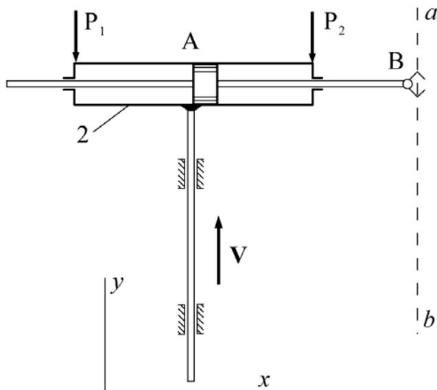
Манипулятор на базе пневмоцилиндра работает в горизонтальной плоскости. Известно, что цилиндр движется с постоянной скоростью  $V$ , направленной по оси  $y$ . Схват  $B$  движется вблизи линии  $ab$ . Масса поршня  $A$ , штока  $AB$  и схвата  $B$  равна  $m$ . Давление воздуха в левой и правой полостях цилиндра  $P_1$  и  $P_2$  соответственно; площадь сечения цилиндра  $S$ . За обобщенную координату принять координату  $x$ , отсчитываемую от положения схвата на траектории  $ab$ .
