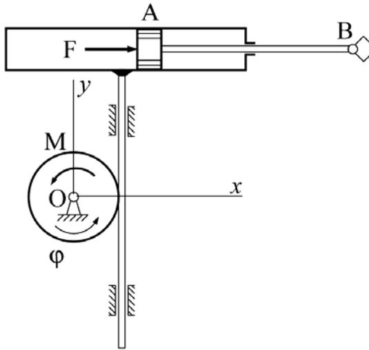
Манипулятор работает в горизонтальной плоскости. Известно, что масса поршня А, штока АВ и схвата В равна  $m_1$ ; масса цилиндра и рейки  $m_2$ ; масса колеса  $m_3$ , его радиус  $r$ ; сила:  $F_x = -a_1 V_{Ax} - b_1 x$ ; момент:  $M_z = U_z - a_2 \omega_z - b_2 \varphi$ ,  $U_z$  – управление,  $a_1, a_2, b_1, b_2$  – константы. За обобщенные координаты принять координату  $x$  поршня А и угол  $\varphi$ , которые отсчитываются от положения равновесия.
