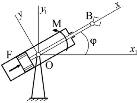
Манипулятор работает в вертикальной плоскости. Известно, что масса схвата В равна  $m_1$ , момент инерции цилиндра  $I_{0z}$ , его центр масс совпадает с шарниром О,  $F_x = F_{0x} + U_x - \mu_1 \dot{x}$ ,  $M_z = M_{0z} - \mu_2 \dot{\varphi}$  управление  $U_z = -N(x - x_0)$ ,  $\mu_1, \mu_2, N$  – константы. За обобщенные координаты принять угол  $\varphi$  и координату  $x$  схвата. Массой поршня пренебречь.
